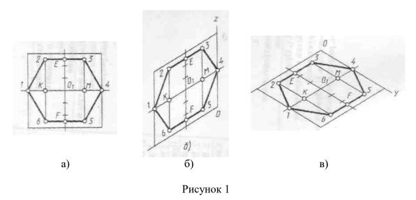
Поместите на чертеже шестиугольник в квадрат, разделите горизонтальную ось квадрата на 4 части, а вертикальную — на 6 частей (см. рис. 1,а). Определите плоскость проекции, в которой он расположен и оси координат.
